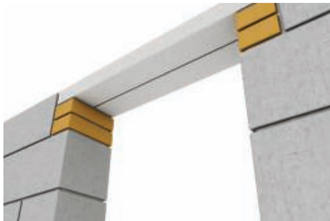
Rys. 19 Otwór okienny przesklepiony nadprożami KONBET SBN 72/120.
